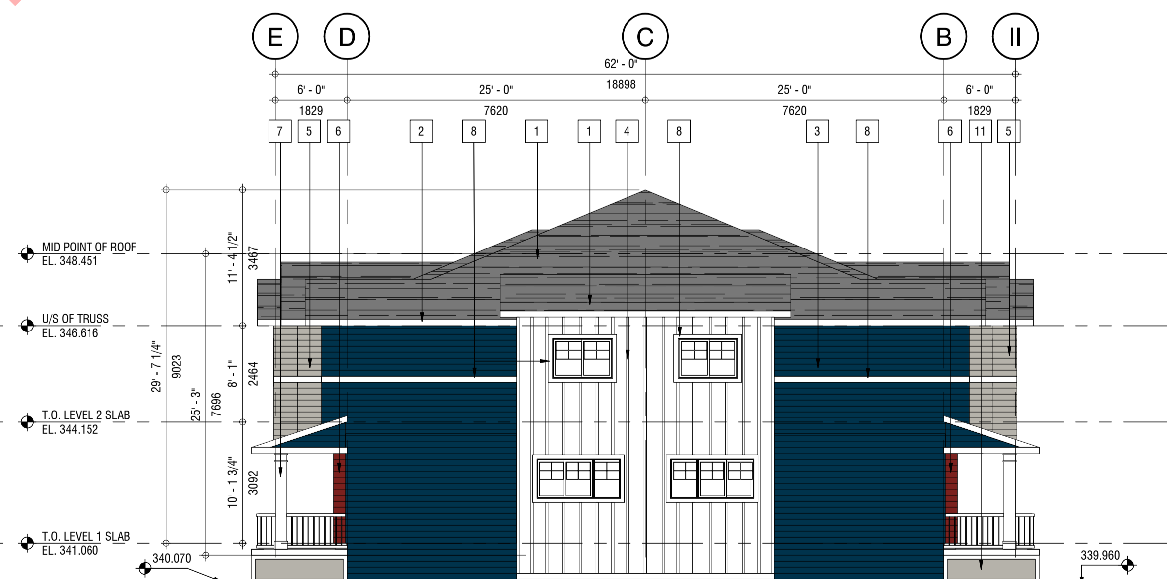
3 West Elevation DP-A4.0 SCALE: 1/8" = 1'-0" DP-A2.0
